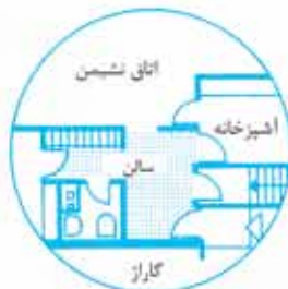
❶ درب ورودی جنب پله های زیر زمین
