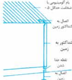
۳. پوشش آلومینیومی بام به عنوان یک کنداکتور صاعقه
