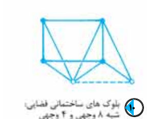
شبکه ۴ خانه سازه فضایی شبه ۸ وجهی و ۴ وجهی در یک وضعیت چرخشی ( 45^\circ ) درجه
