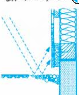
۱۳ ساختار قابل تعویض پوششی که بسیار در معرض هوا قرار دارد
