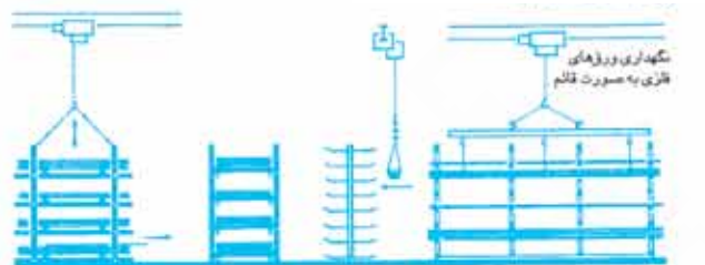
انبار کرن افقی و جابه جایی صفحه ها و میله های فولادی
