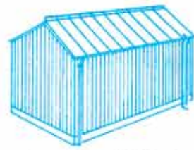
۱. بام ورقه‌ای یا دیوارهای چوبی: بام به کنداکتور خط الرأس و کنداکتور به زمین متصل است.
