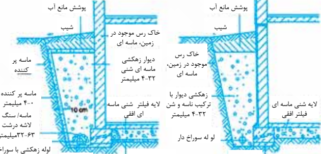
۷ فشار دائمی با عایق بندی مقاوم
