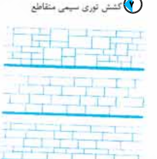
دیوار کشی لایه لایه با لایه های سنگی
