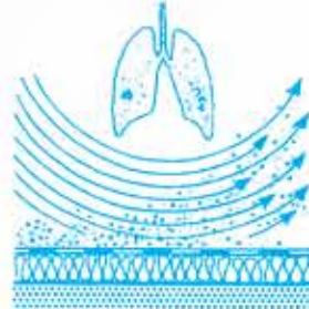
۱۲. تولید گرد و غبار (شکل ۸) در یک بام متعارف
