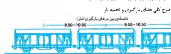
سکوهای انبار ریل برای بارگیری، تخلیه بار و بارگیری انتقالی
