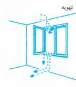
۱۶ ورود هوای خنک به اتاق : خروج هوای گرم
