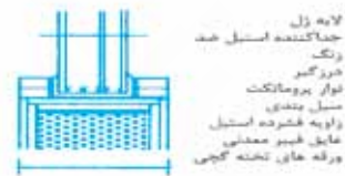
● دو صفحه شیشه ای ایمنی منفرد و فشرده پانل شیشه ای در بیرون، یک شیشه شادور میان لایه های ژل
