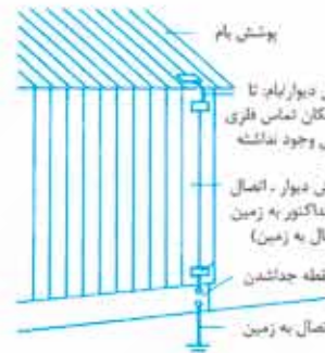
۳. پوشش آلومینیومی بام به عنوان یک کنداکتور صاعقه
