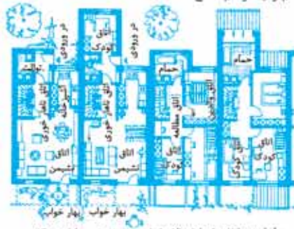
۴ خانه های هم ردیف : همه مجراهای تأسیسات خانه در یک کانال قرار دارند
