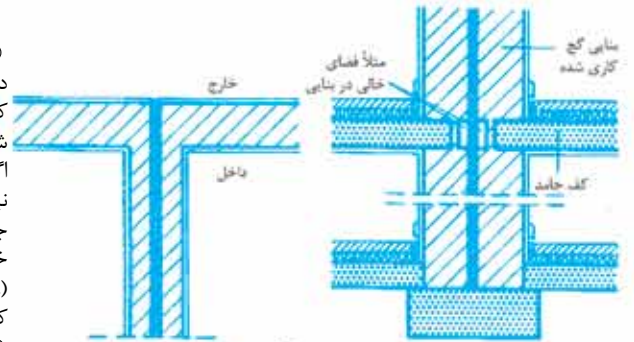
❷ دیوار تقسیم کننده دو جداره با فضای خالی (نمای طرح)
