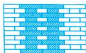
۱۳ دیواری تقویت شده با ۱/۴ ضخامت آجر (آجرها در لبه ها) با ۸ پانل آجری ۱۴ مانند ۱۳، با ۳ پانل آجری ۱۵ مانند ۱۳، با ۴ ۱/۲ پانل آجری ۱۶ دیوار با آجر تقویت شده، ۱/۲ ضخامت آجر با ۴ پانل آجری
