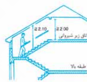
۹ قراردادن تیر عرضی طاق و تیرک ها به موازات پله ها موجب می شود فضای کمتری اشغال شود و مانع از تغییرات پرهزینه می گردد.
