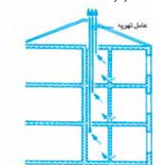
سیستم تهویه مرکزی با کانال تخلیه هوا از طریق پشت بام
