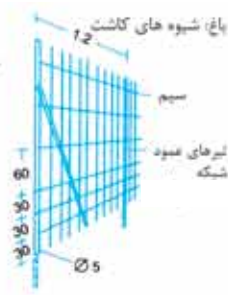
۴ قاب شبکه از جنس لوله های مخزن بخار آب است
