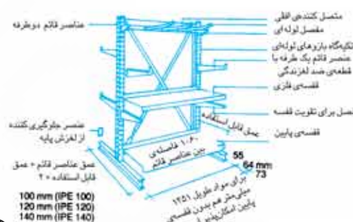
سیستم طاقچه بندی پالت برای پالت های یورو ( به ترتیب شماره ها)
