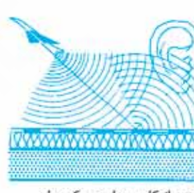
۱۶. انعکاس صدا روی یک سطح سخت (یک بام متعارف)
