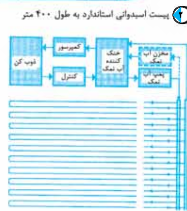
۶ زمین پاتیناز مصنوعی: طرح کلی سیستم سرد سازی (آب نمک)
