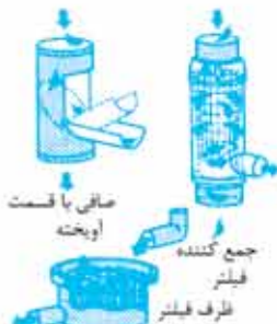
۲. فیلتر پیش از ذخیره سازی آب باران
