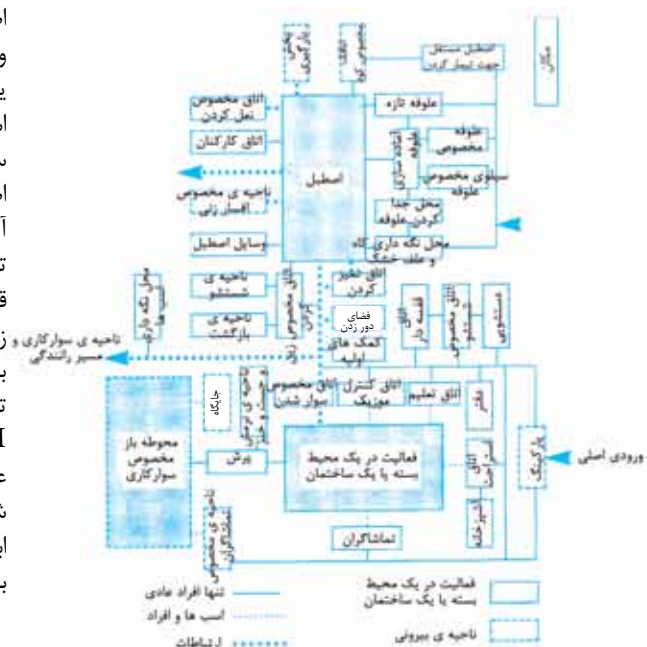
بخش ها و قسمت های داخلی یک ناحیه مخصوص سوارکاری
