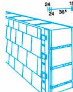
سفالهای آویزان روی بلوکهای عایق سازی شده
