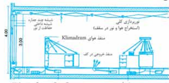
۱۰ بخش سیستمی برای کنترل هوای Klimadrant برای میزهای شخصی
