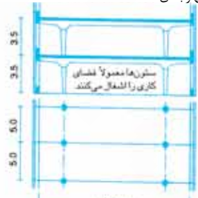
شاه تیرهای اهرمی ممکن است مزایای ساختاری داشته باشند و لم، فضا، محدود می کنند.
