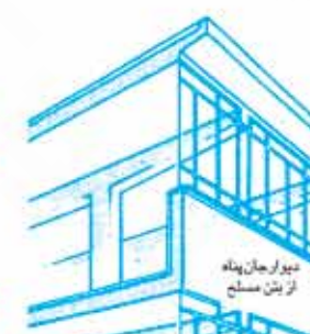
۷ ساختاری از بتن آرمه با ستونهای داخلی، کف نرده ای و پنجره های پیوسته روبانی دیواری از سنگ سبک
