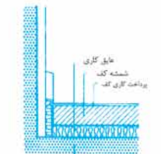
❼ گچ کاری در پایین کف زیر شمشه کف قرار به کار می شود. شمشه کف به کار می رود.
