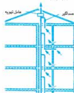
سیستم تهویه هوای مرکزی با کانال های اصلی و فرعی
