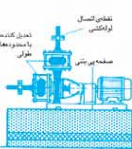
نصب نایسبات با اتصال الاستیک به پی
