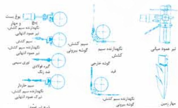
شرح کشش در حصار شبکه سیمی بهم پیچیده اتصال ۷
