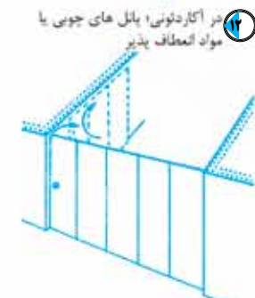
۱۵ در ریلی لولدار، حول یک گوشه می چرخد (Rail door, around a corner it rotates).
