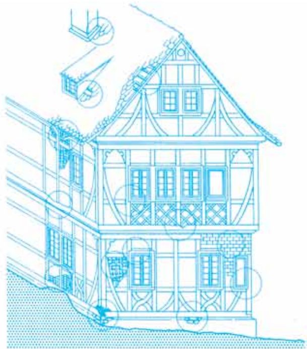
فضاهای اصلی آسیب دیده در ساختمانهای نیمه چوبی
