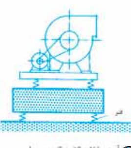
ویژه با لایه الاستیک دو جداره برای تهویه کننده
