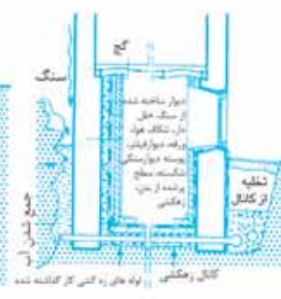
۴ ضد رطوبت کردن از داخل به واسطه دیوارهای بیرونی نسبتاً دور از دسترس
