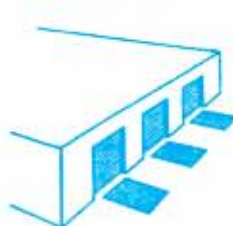
سکوی هم سطح زمین، بارگیری با پلکان‌ها یا سطح بالابر \leftarrow 7
