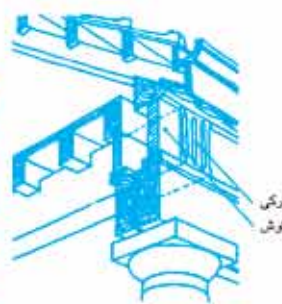
۱ ساختارهای اصلی ساخته شده از الوار که به عنوان پایه و اساس طراحی در معابد یونانی به کار گرفته می شد.
