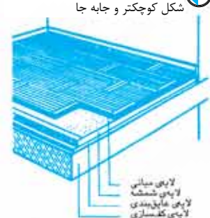
❹ اجزای پارکت شده پایانی (لایه آخر) روی پوشش بام، لایه میانی - پوشش، لایه عایق صفحه بام
