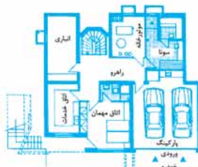
زیرزمین ، خانه روی شیب شمالی ۲ + ۳
