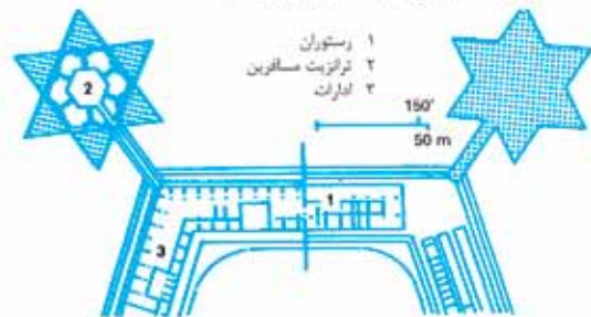
فرودگاه Gologne - Bonn ، کف ثانویه (سیستم ماهواره ای)
