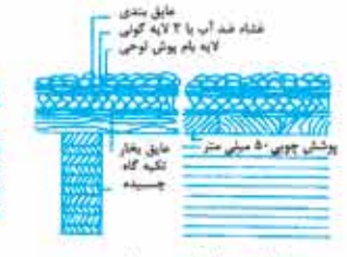
۷ بام گرم با الوار چند لایه و پوشش با الوار مسطح
