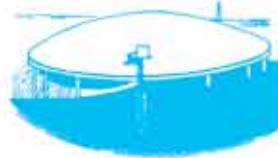
۱۳ نایمز، فرانسه: سقف بالشی باد شده که به حلقه هایی متصل است و از ردیف بالایی جایگاه استادیوم نگهداری می کند.
