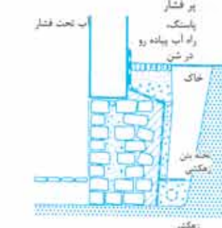
۱ تعمیرات بخش خاکی فونداسیون بنا
