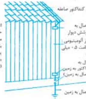
۶. پوشش آلومینیومی دیوار به عنوان کنداکتور متصل به زمین به کار می‌رود
