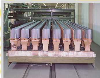
تصویر شماره ۹۸. واگن مخصوص حمل سرامیک‌ها در کوره
