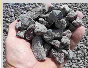
تصویر شماره ۲.۱۳. سنگ‌دانه‌های مصرفی در بتن
