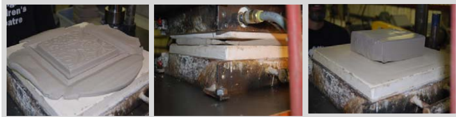
تصویر شماره ۸.۸. قالب گیری گل به روش پرس (به ترتیب از راست به چپ)
