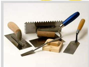
تصویر شماره ۳.۱۱. ابزارهای اجرای ملات و اندودکاری
