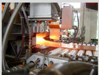
تصویر شماره ۳.۱۸. شکل دادن به شیشه به طریقه نورد
