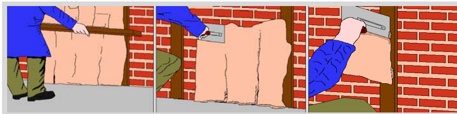
تصویر شماره ۴.۱۱. اندود کردن دیوار (از راست به چپ)
