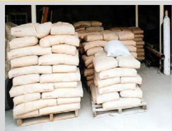
تصویر شماره ۱۹.۱۲. نحوه انبار کردن سیمان
